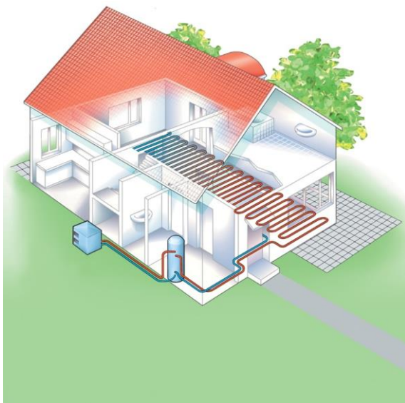
Lucht-waterwarmtepomp, bron: Stiebel Eltron
