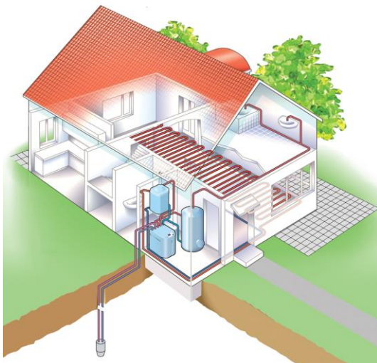
Bodem-waterwarmtepomp met verticale grondwarmtewisselaar, bron Stiebel Eltron
