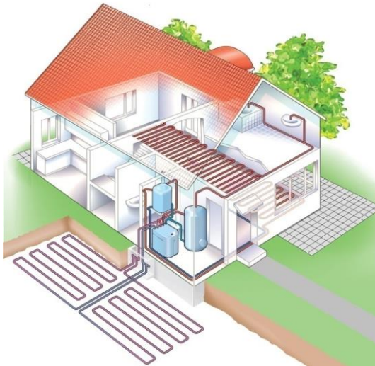
Bodem-waterwarmtepomp met horizontale grondwarmtewisselaar, bron Stiebel Eltron
