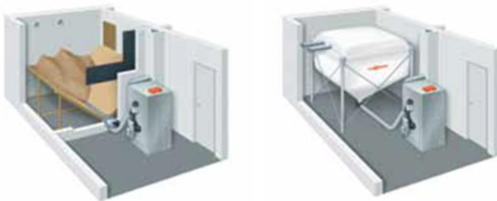
Opslagruimte/ pelletsilo (Bron: Viessmann)
