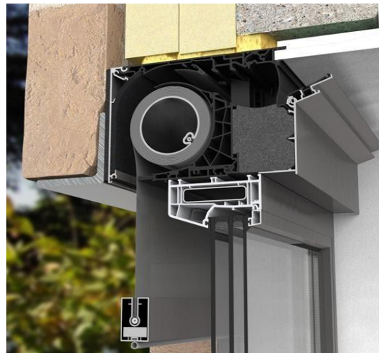
Inbouwscreen gecombineerd met ventilatierooster (afbeelding: Renson)
