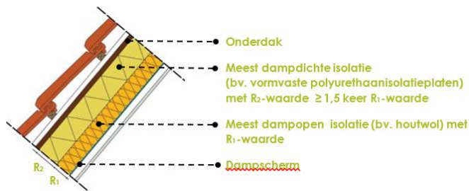
Hellend dak met de meest dampdichte isolatie aan de buitenkant kan enkel als R_2 \geq 1,5 \times R_1 (illustratie: Dialoog vzw)
